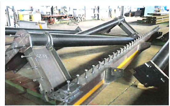
▶入口の柱:鉄骨(名古屋で作成)
